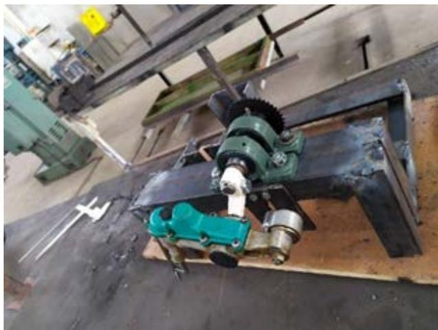
Gambar 1. Alat Demonstrasi Lengan Tanam (tampak samping)
